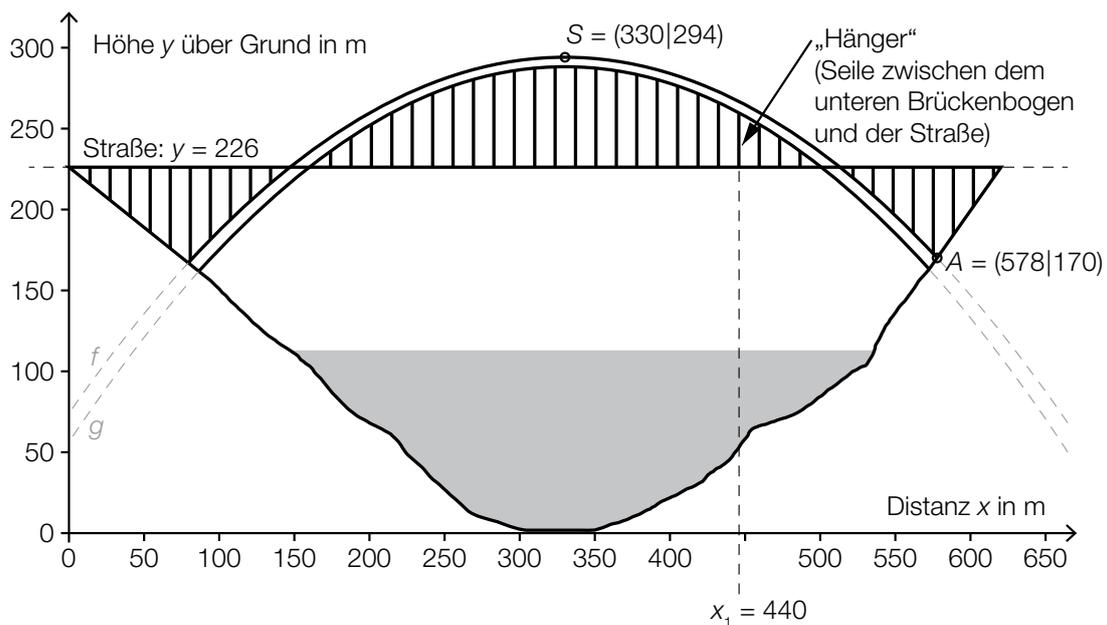
Die obige Abbildung stellt modellhaft die Wushan-Brücke dar. Der obere und der untere Brückenbogen werden durch die Graphen der quadratischen Funktionen  $f$  und  $g$  dargestellt. Der Punkt  $S$  ist der Scheitelpunkt der Funktion  $f$ .
